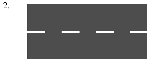
“LÍNEA DISCONTINUA” de color blanco. Divide dos carriles que poseen el mismo sentido de circulación. Indica permisión para adelantar o cambiar de carril.
